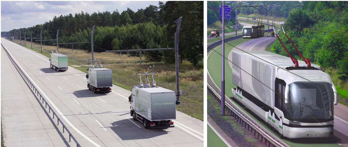
RYSunEK 7.9. Po lewej: testy systemu eHighway Siemens, po prawej tir w futurystycznej wersji 35 .
