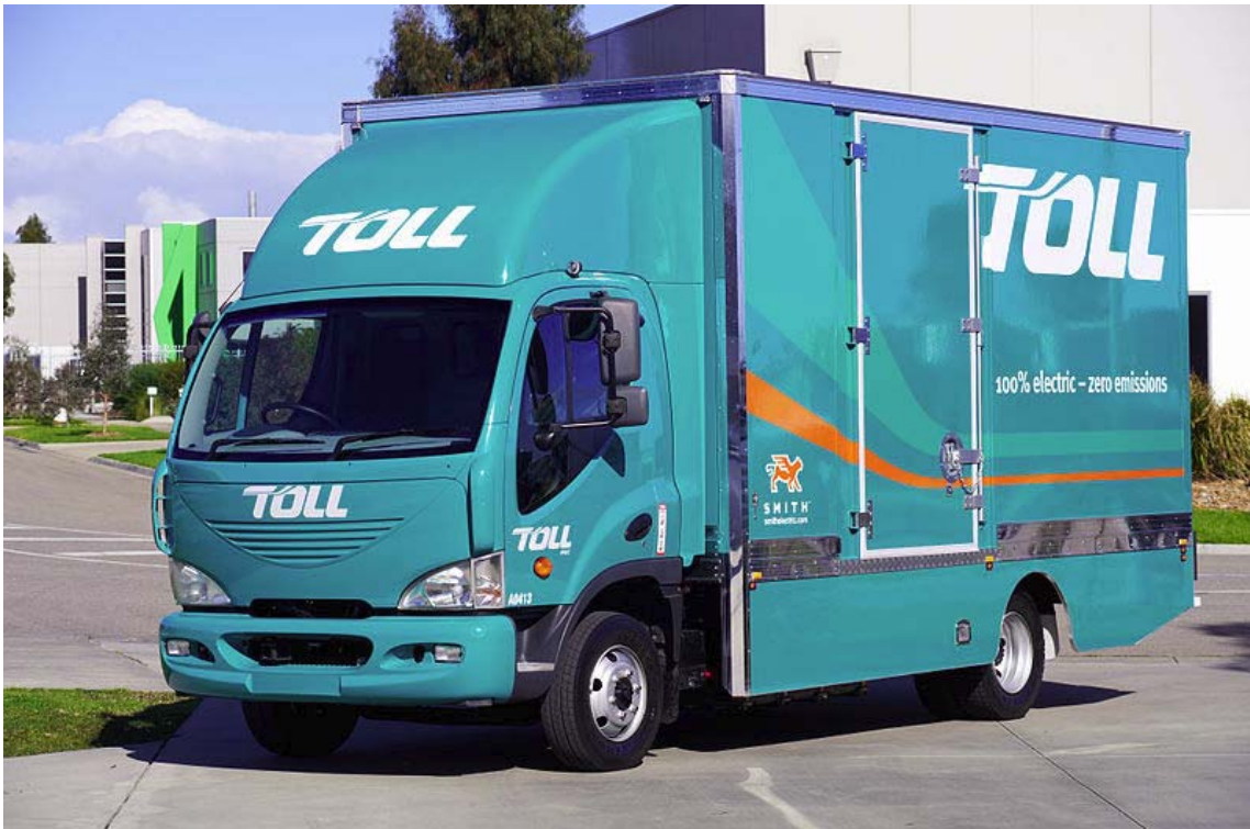
RYSunEK 7.10. Dziesięcotonowa ciężarówka elektryczna Smith Electric o zasięgu 200 km 36 .
